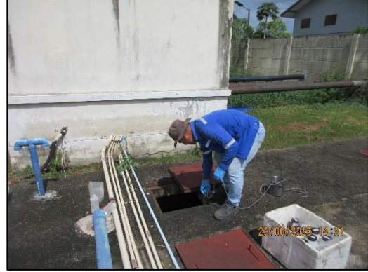
รูปที่ 3.1-3 จุดตรวจวัดคุณภาพน้ำทิ้ง บ่อตรวจสอบคุณภาพน้ำหลังผ่านการบำบัดของเฟสที่ 1 ประจำเดือนมกราคม - มิถุนายน พ.ศ. 2568
